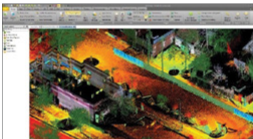
Объединение облаков точек с изображениями и данными съемки позволяет легко создавать точные и наглядные выходные материалы
