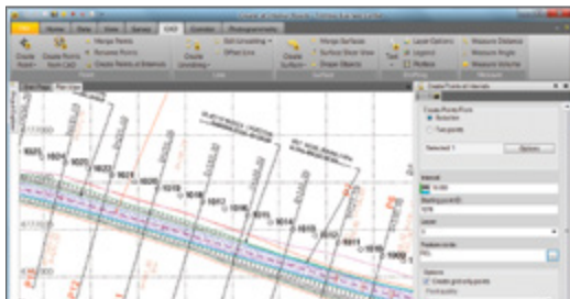
Автоматическое создание точек со сдвигом в плане и по высоте от объекта для разбивки
